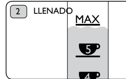
Llene la jarra por la abertura de la tapa. Utilice al menos una taza de agua (250ml). El nivel de agua debe permanecer debajo de la marca "max". Ahorre energía: hierva solo la cantidad justa. Mantenga constantemente la jarra en posición vertical y nivelada durante el llenado (con una inclinación máxima de 15°). No incline la jarra hacia atrás. **NO LA LLENE POR EL PICO NI LA DEJE REBALSAR.**
