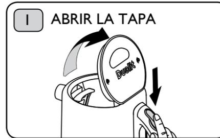
Asegúrese de que la jarra esté desenchufada. Retire la jarra de la base eléctrica. Tire del asidero hacia arriba y hacia el asa para abrir la tapa. La tapa es articulada para facilitar su apertura y cierre.
