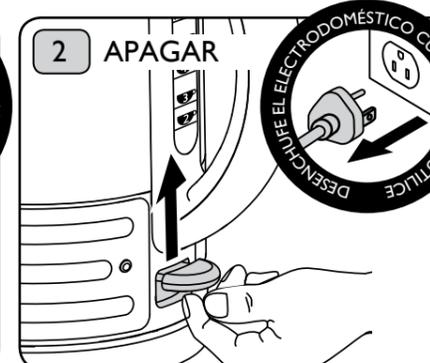
La jarra se apagará automáticamente una vez haya hervido el agua y entonces se apagará la luz de neón. Para apagar la jarra antes de que hierva el agua, levante el pulsador de encendido/apagado. **Siempre desenchufe la jarra luego de utilizarla.**
